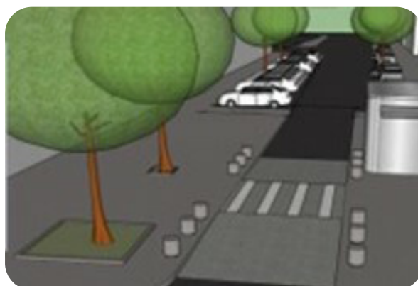
Figura 4 - Reabertura da praça na Rua Almirante Gonçalves, como uma via de serviços de 4,5 m de largura
