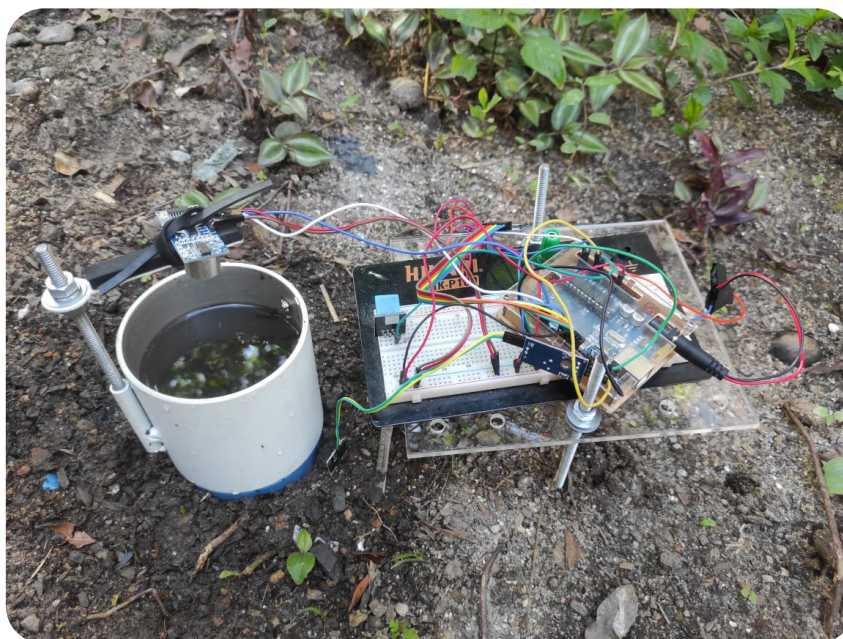
Figura 4 – Versão inicial do protótipo com infiltrômetro e protótipo acoplado fincado no solo
