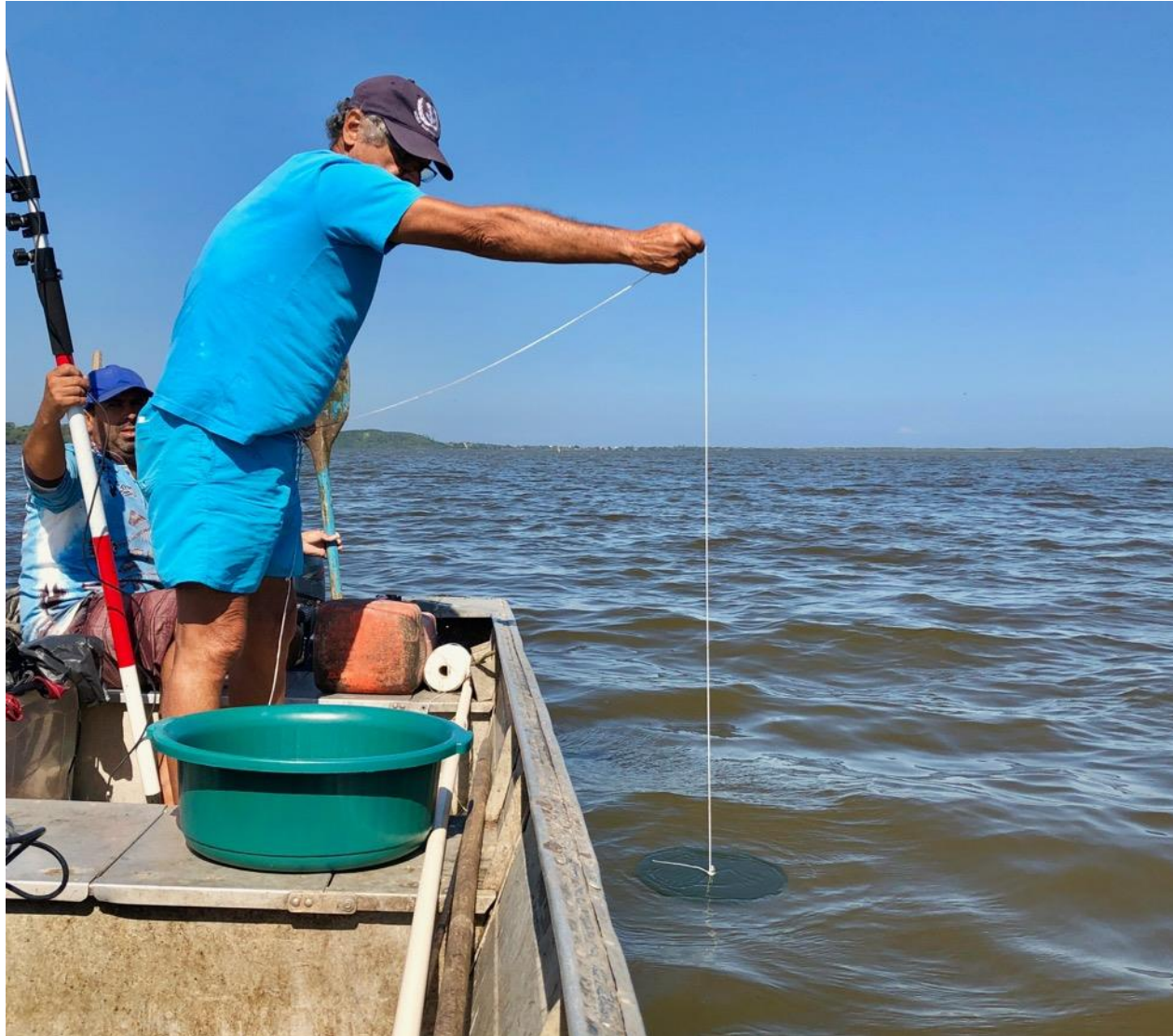
Aferição da profundidade do topo da lama
