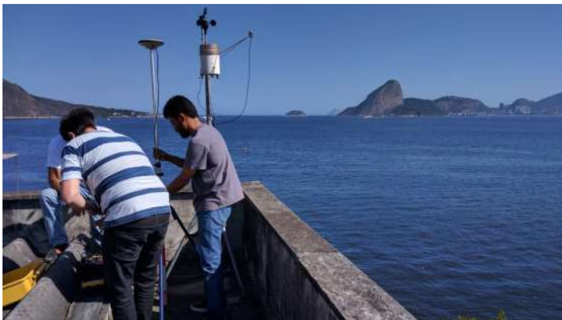
Figura 3. Montagem da antena fixa sobre ponto geodésico situado no topo do prédio do Instituto de Geociências (UFF).
