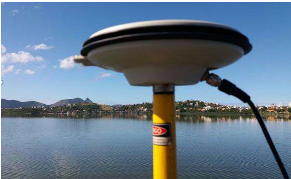
Figura 4. Antena posicionada sobre um ponto de monitoramento na lagoa de Piratininga.
