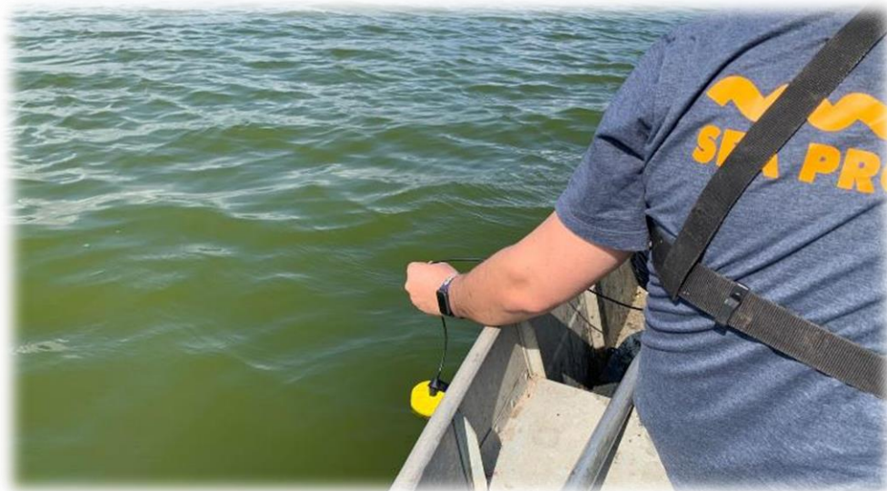
Figura 6 - Sonda de profundidade digital Hondex em uso
