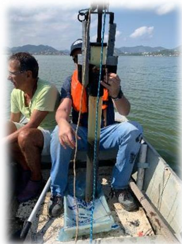
Figura 2 – Corer Gravimétrico – coleta sedimento
