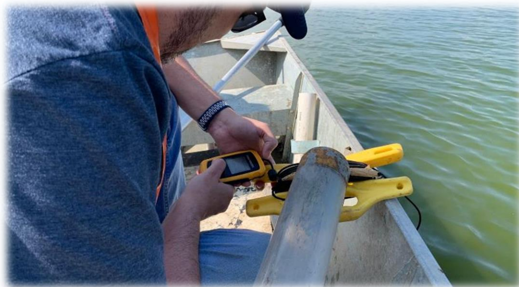
Figura 7 - Sonar auxiliar FF1198 Lucky em uso.
