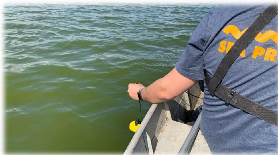
Figura 6 - Sonda de profundidade digital Hondex em uso
