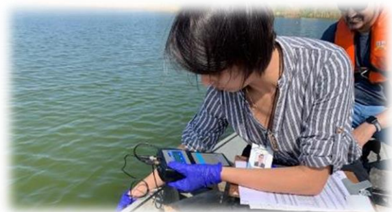
Figura 10 – Técnica do Laboratório QalyLab fazendo aferição do pH e OD
