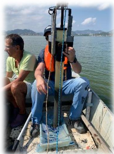
Figura 2 – Corer Gravimétrico – coleta sedimento
