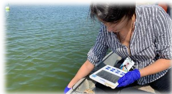
Figura 9 – Técnica do Laboratório QalyLab fazendo aferição do pH e OD
