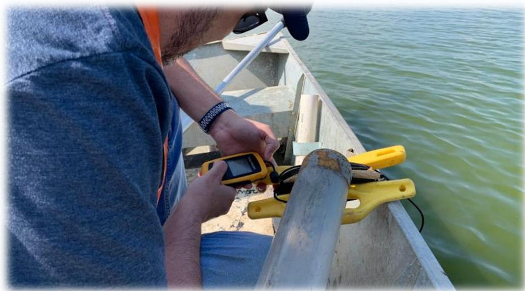
Figura 7 - Sonar auxiliar FF1198 Lucky em uso.
