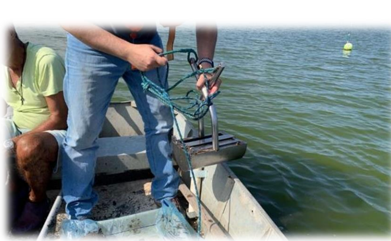
Figura 3 – Van Veen – Amostrador de sedimento
