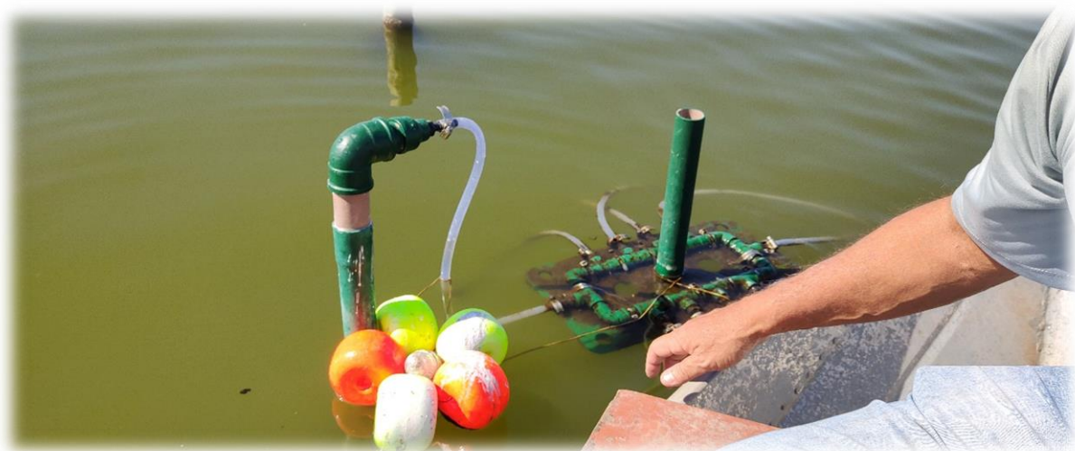
Foto 8 – PC Ponto Central com a distribuição do Biorremediador com as mangueiras de dosagem automática
