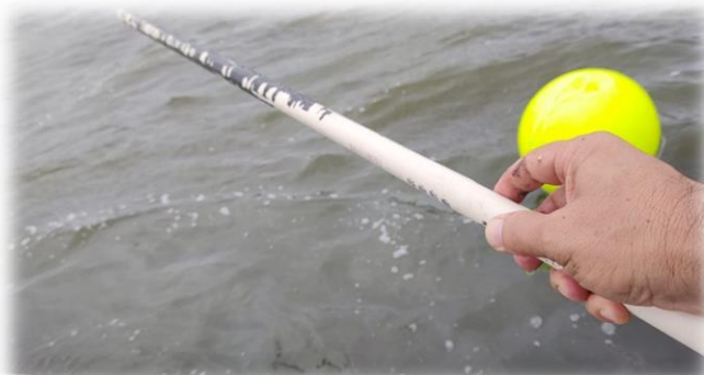
Foto 6 – Tubo PVC introduzido nos pontos para verificação da camada de lodo
