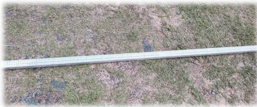
Foto 8 – Régua de alumínio com escala métrica usada na Batimetria
