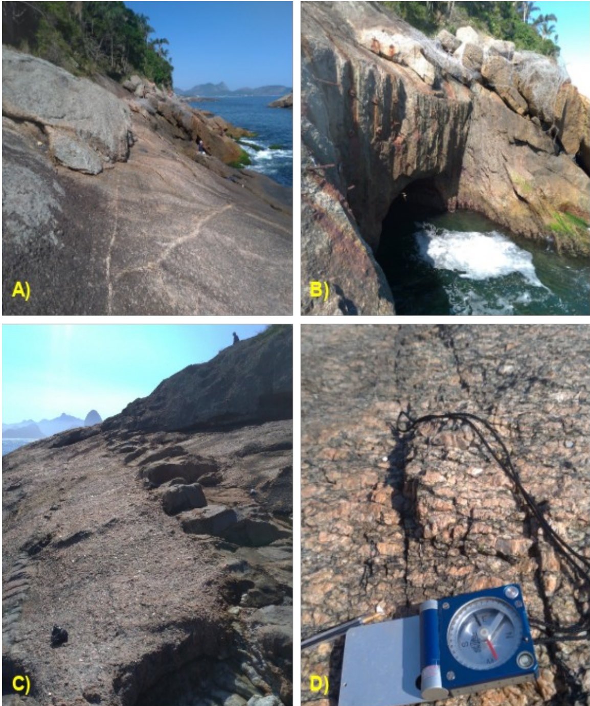
Figura 5.2-1. A) Vista Geral do maciço granitóide com foliações gnáissicas, apresentando veio de quartzo discordante da foliação, com veio pegmatítico concordante com a foliação (N340/80°); B) Desemboque do túnel, em corte de rocha, no qual notam-se estruturas de alívio de pressão, com direção e mergulho no mesmo ângulo do costão rochoso, contudo com atitude favorável para escorregamentos planares, quando em corte, notar a densidade de elementos de fixação (tirantes) na face de corte; C) Vista de um dique orientado segundo foliação (N280-100), de composição máfica, e muito suscetível à intemperismo; D) Aspectos dos fenocristais da rocha, em trecho com juntas de atitude N140/85°, discordantes da foliação.
