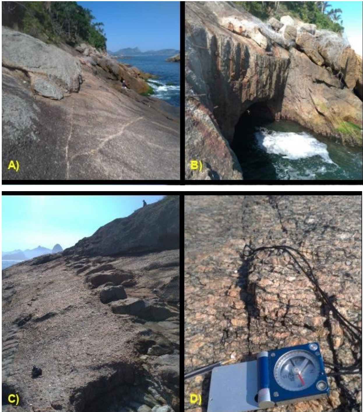
Figura 5.2-1. A) Vista Geral do maciço granitóide com foliações gnáissicas, apresentando veio de quartzo discordante da foliação, com veio pegmatítico concordante com a foliação (N340/80°); B) Desemboque do túnel, em corte de rocha, no qual notam-se estruturas de alívio de pressão, com direção e mergulho no mesmo ângulo do costão rochoso, contudo com atitude favorável para escorregamentos planares, quando em corte, notar a densidade de elementos de fixação (tirantes) na face de corte. C) Vista de um dique orientado segundo foliação (N280-100), de composição máfica, e muito suscetível à intemperismo; D) Aspectos dos fenocristais da rocha, em trecho com juntas de atitude N140/85°, discordantes da foliação.
